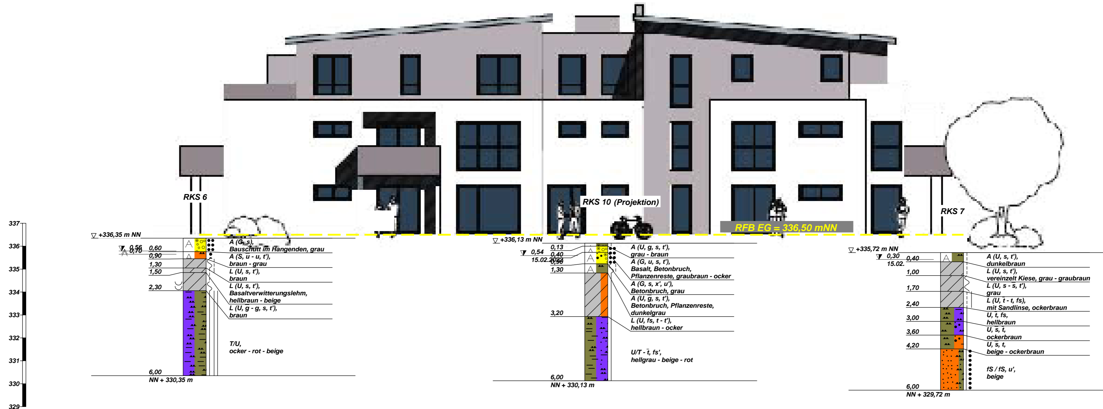
Geotechnischer Systemschnitt 3 "Gebäude 2" - Ansicht Nordost Maßstab 1 : 100
