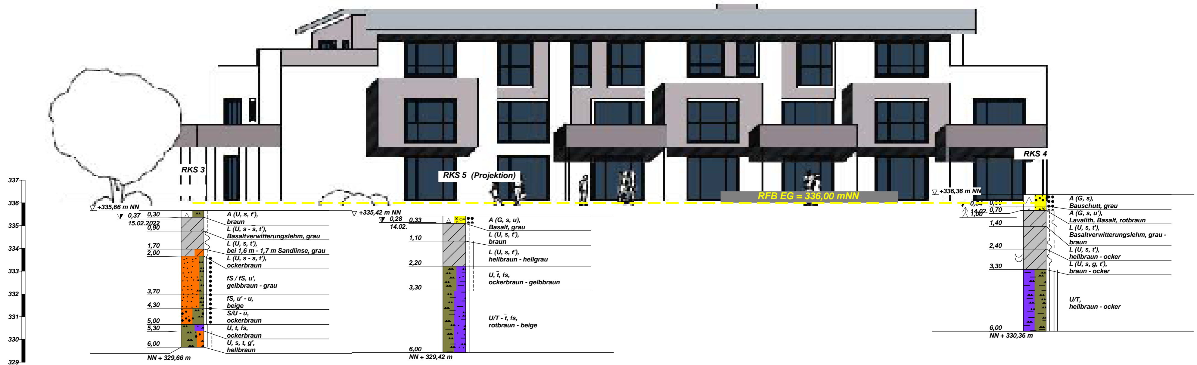
Geotechnischer Systemschnitt 2 "Gebäude 1" - Ansicht Süd Maßstab 1 : 100
