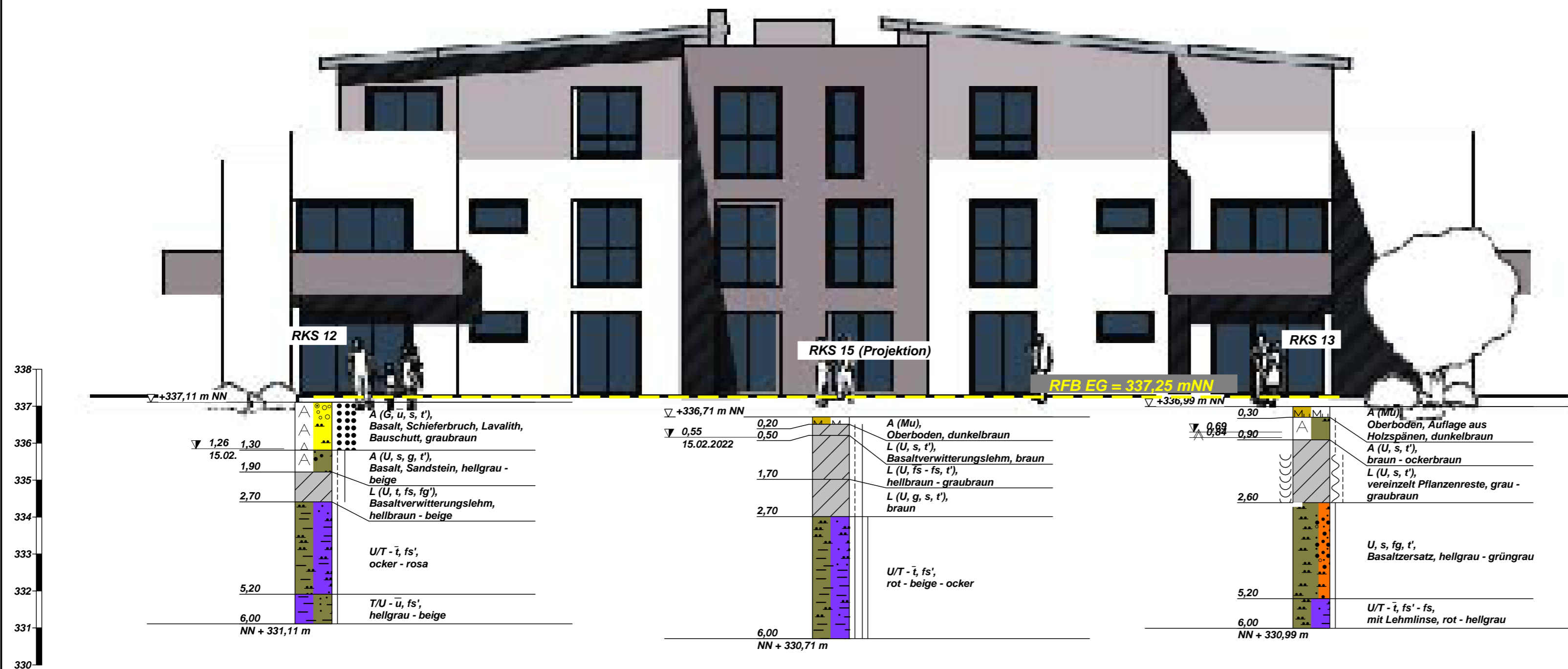
Geotechnischer Systemschnitt 6 "Gebäude 3" - Ansicht Südwest Maßstab 1 : 100
