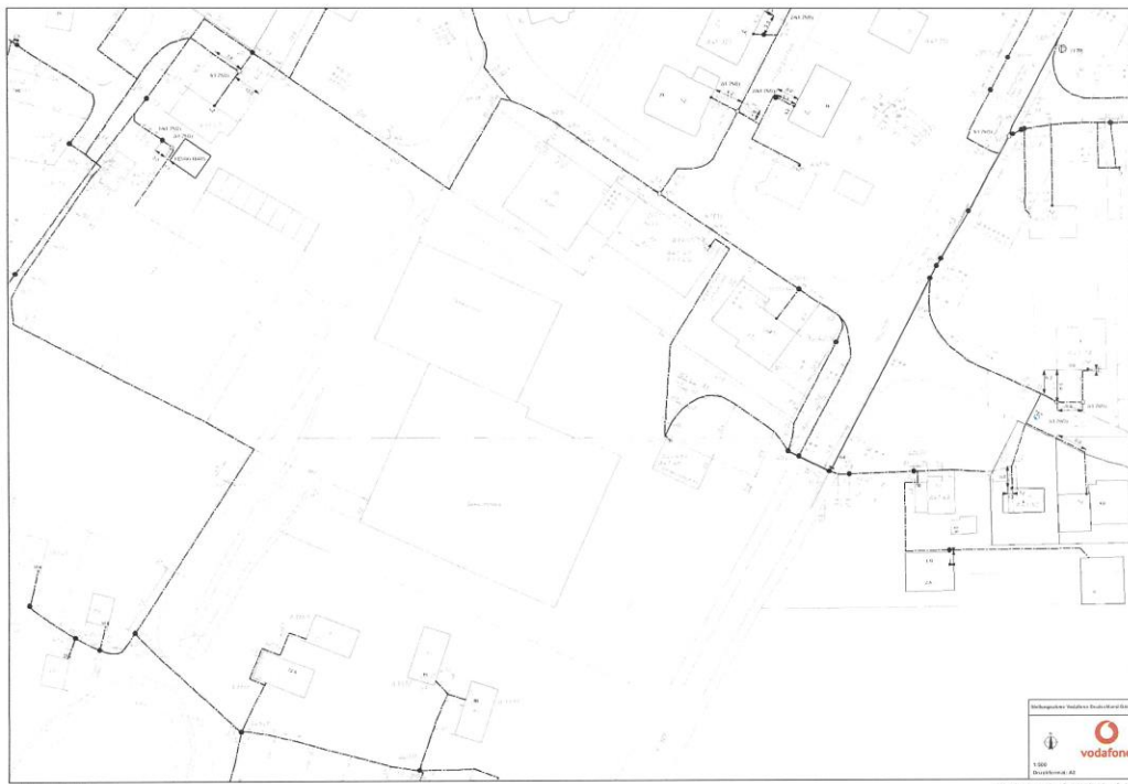
Lageplan Telekommunikationsleitungen Vodafone
