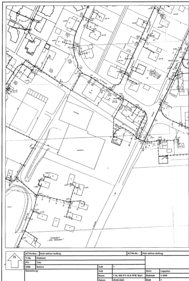
Lageplan Telekommunikationsleitungen der Telekom
